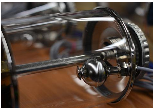
Abb. 3a-3c: Einbau der Jacob Schwimmerschalter in der Fertigung bei der L.+G. Beck GmbH
